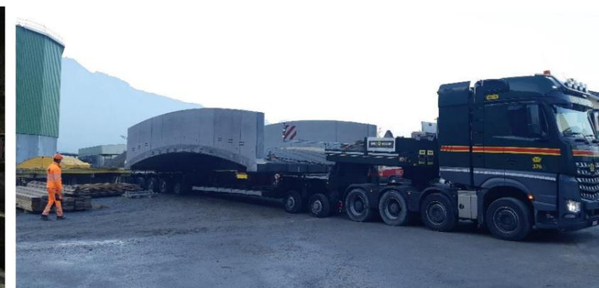
Chargement du pont préfabriqué au dépôt
